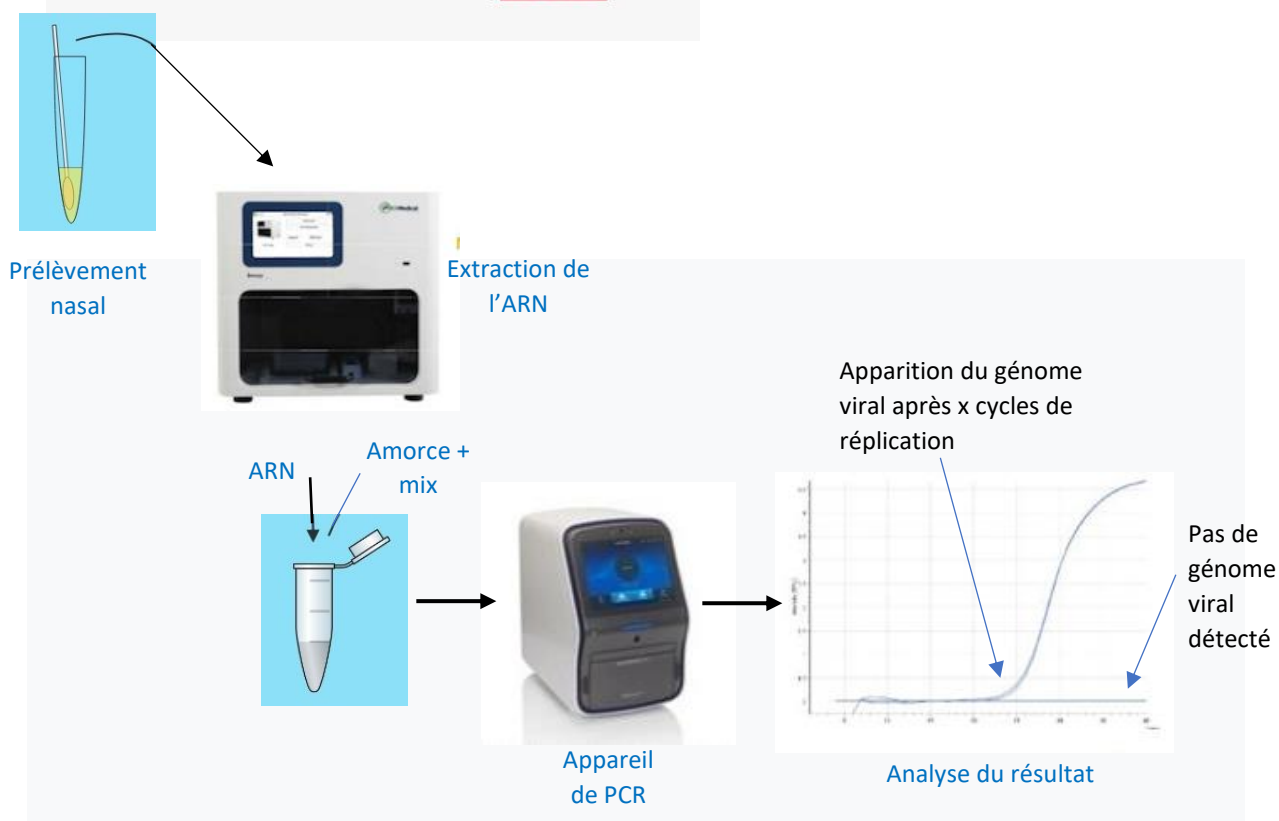
Figure 12 : Résumé des différentes étapes du test PCR (mesure de la charge virale dans un prélèvement nasal).
